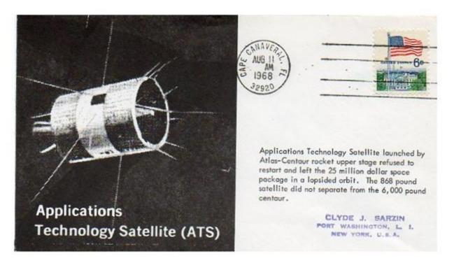
L'ATS - 4 è stato lanciato per valutare la stabilizzazione gravità gradiente e le nuove tecniche di imaging per il recupero dei dati meteorologici. La sonda è stata disattivata dopo 61 minuti quando il razzo Centaur non è riuscito a prendere fuoco.
