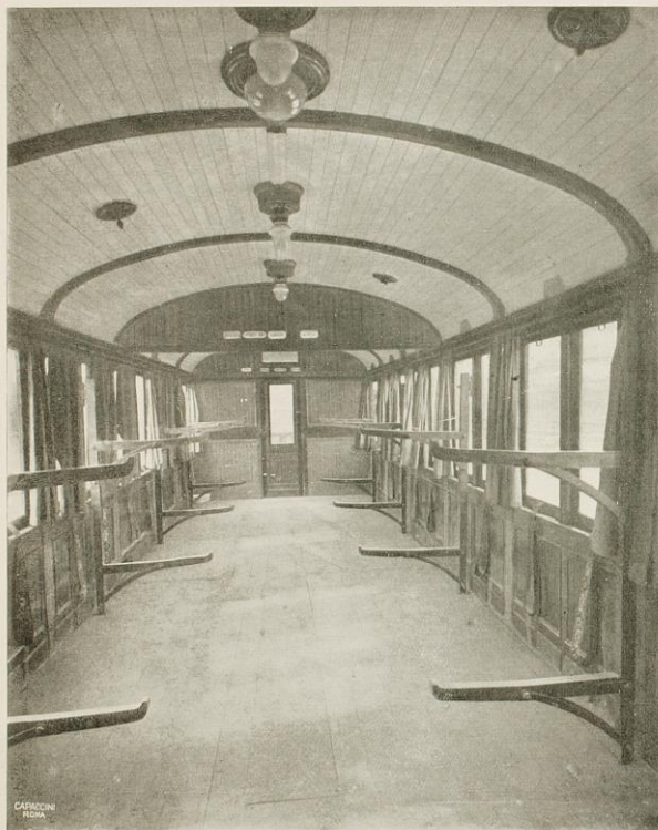
Carrozza di III classe con terrazzini. Serie CT, ridotta per « Infermeria isolamento », con 14 barelle. Carrozza N. 14 del treno. Interno dimostrante la disposizione dei montanti porta-barelle.
