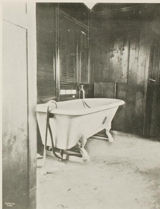
Carrozza di III classe a carrello, tipo 1910 ridotta ad uso «Sala di medicazione, Farmacia e Riparto per 12 infermi». Carrozza N. 12 del treno. Interno della cabina da bagno.
