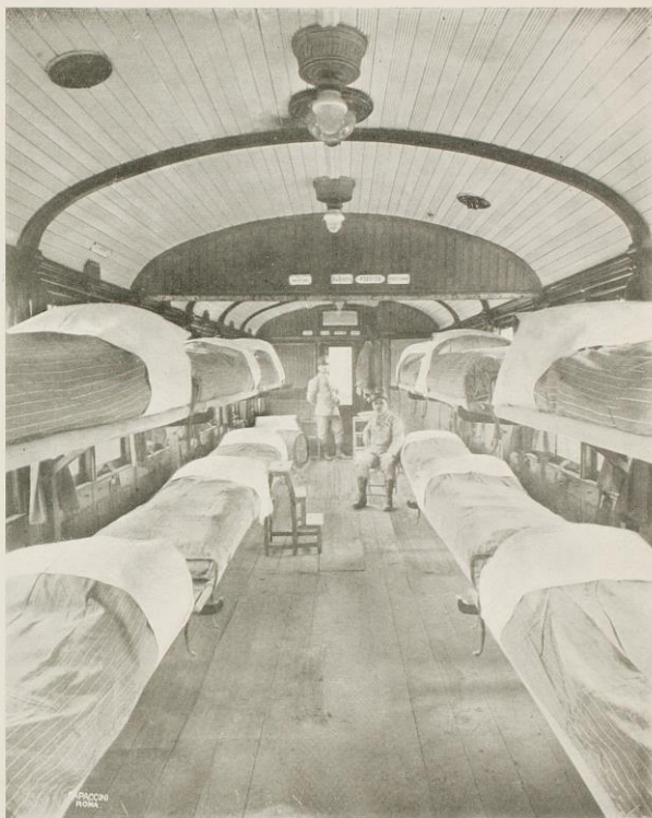
Carrozze di III classe a carrelli, Serie C/2 tipo 1910 ridotte ad uso « Infermeria per 24 infermi, in due Riparti ». Carrozze N. 5 a 11 del treno.
