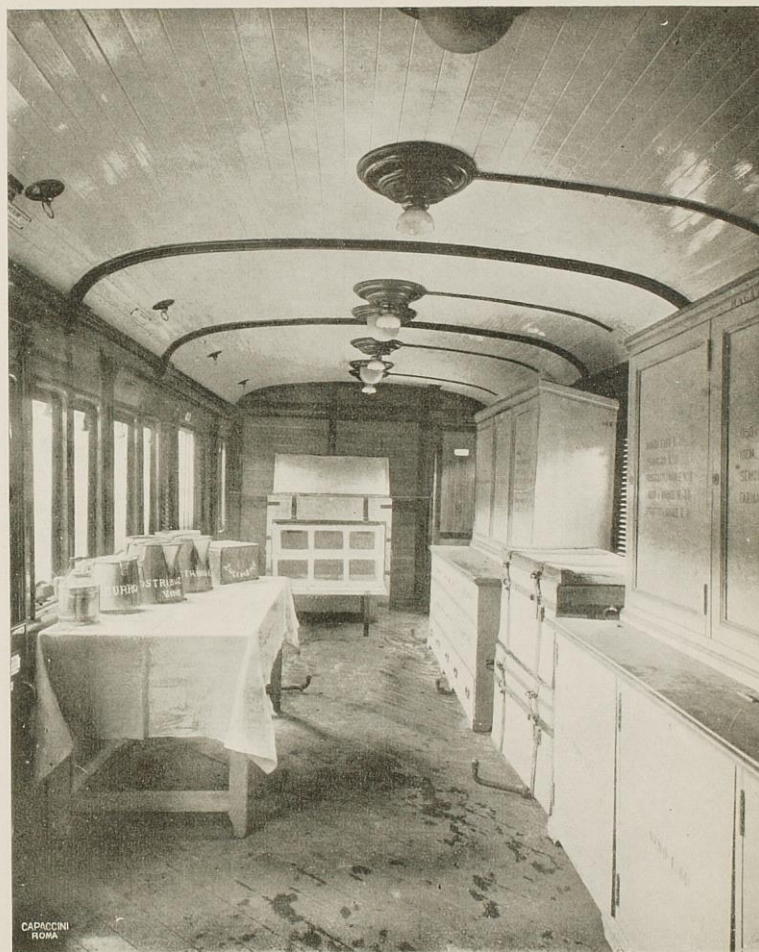
Carrozza di III classe a carrelli, tipo 1907, ridotta ad uso Mensa, Magazzino viveri e Riparto per 12 infermi. Carrozza N. 4 del treno. Interno del magazzino viveri.
