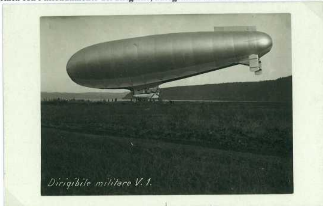
DIRIGIBILE MILITARE V.1 "CITTA' di JESI" - Progettista e costruttore Verduzio 1914. Tipo semirigido, assegnato al Cantiere Città di Ferrara, al comando del Ten di Vascello Brivonesi. Venne abbattuto la notte del 5 Agosto 1915 su Pola con la cattura del comandante e del suo equipaggio.
