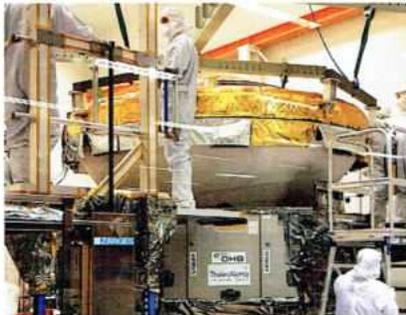
La piattaforma – che contiene il modello termo-strutturale del Rover, protetto dal "Rear Jacket" del modulo di discesa, connesso con il Modulo Carrier fornito da OHB -- è pronta per essere trasferita presso lo stabilimento di TAS di Cannes, dove verranno effettuati i test ambientali.
