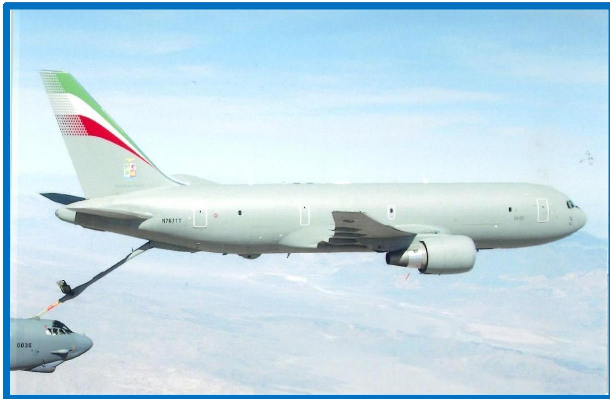
**KC-767/a Aereo Boeing prende parte alle maggiori operazioni internazionali e missioni di supporto nel settore del rifornimento in volo**
