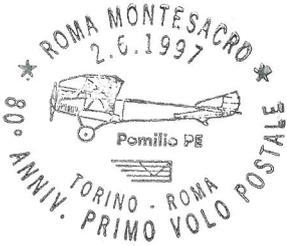
L'annullo riproduce il biplano Pomilio PC, ove C sta per caccia; biposto anche per ricognizione. Fusoliera quadrata, motore anteriore FIAT A.12 di 260 cavalli, lunghezza m. 8,94, apertura alare m. 11,88; velocità max 184 Km/h.
