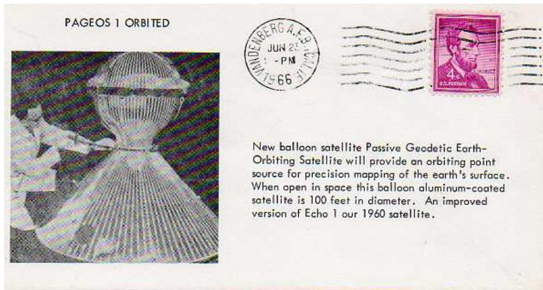
23/06/1966 Il Pageos 1 (Passive Geodetic Earth-Orbiting Satellite) era un satellite mongolfiera che è stato lanciato dalla NASA allo scopo di avere un disegno preciso della superficie della Terra. Aveva un diametro di 30,48 metri ed era costruito con un film plastico rivestito di alluminio. Era una versione migliore dell'Echo 1 lanciato nel 1960.
