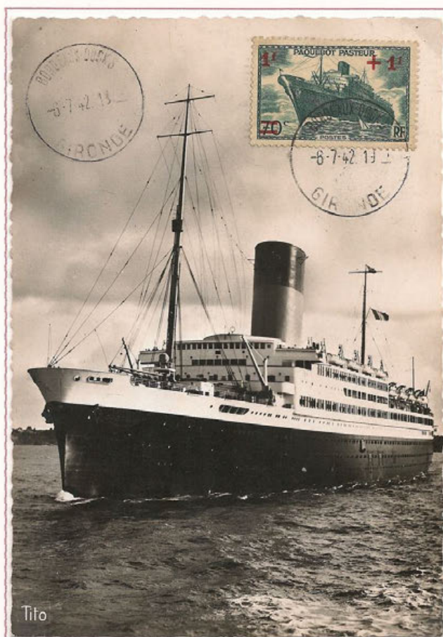
PIROSCAFO - "PASTEUR" Fu in servizio sulla rotta del Sud Atlantico. Lungo 212 metri, 35.000. CV. di potenza e 26 nodi di velocità, varato negli anni trenta.
