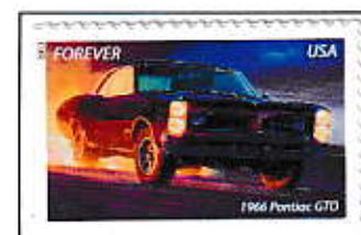
La Pontiac del 1966 aveva adottato caratteristici fari quadrupli impilati verticalmente.
